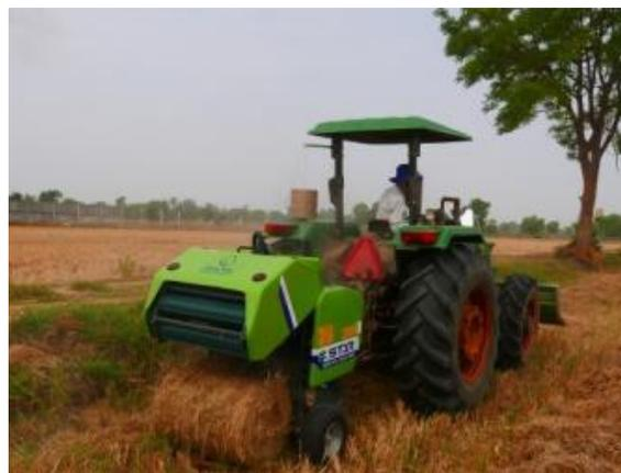
Fig. 4. Small-scale roller baler - (13 kg/bale).
