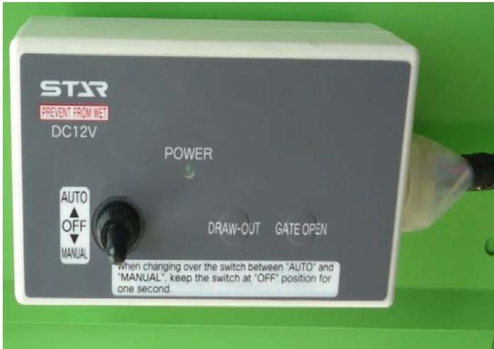
Fig. 20. Control box of a Star baler.
